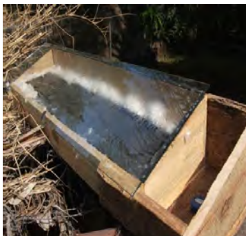
Four à boue expérimental
