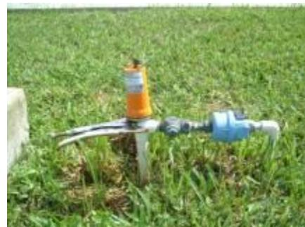
*Les enregistreurs de bruit peuvent être placés sur des raccords dans le réseau.*
