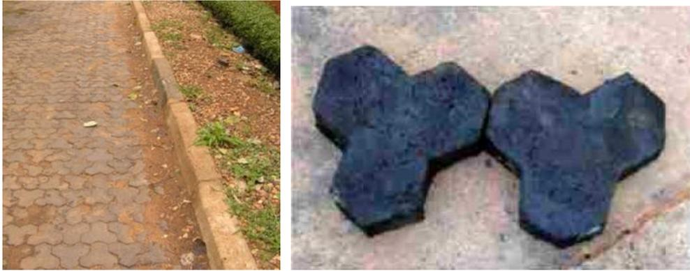
**Photos 14 à 17 : Fabrication de pavés autobloquants à partir de déchets plastiques : four, moules, pavés et route pavée (photos RESEDA et RAIL).**
