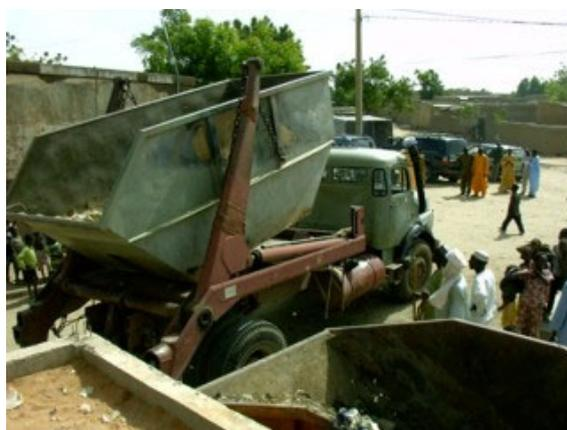
***Photo 13 : Evacuation d'une benne à ordures par un camion poly-benne.***
