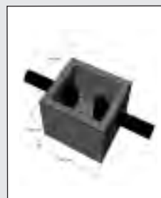
4. Boîte de connexion au réseauégout
