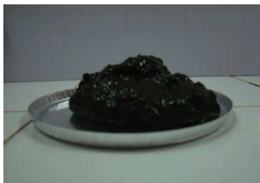
Figure 28 : Aspect type d'une boue dite pâteuse
