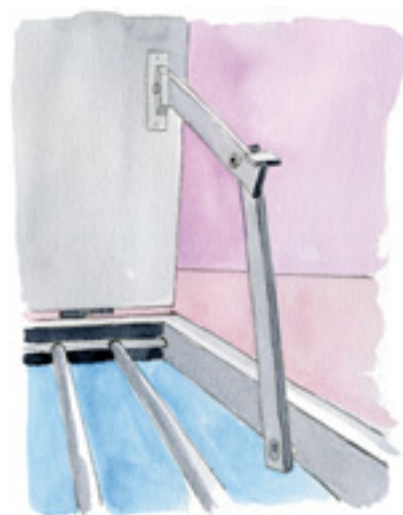
Figure 10. Système de maintien d'ouverture de la trappe par compas.
