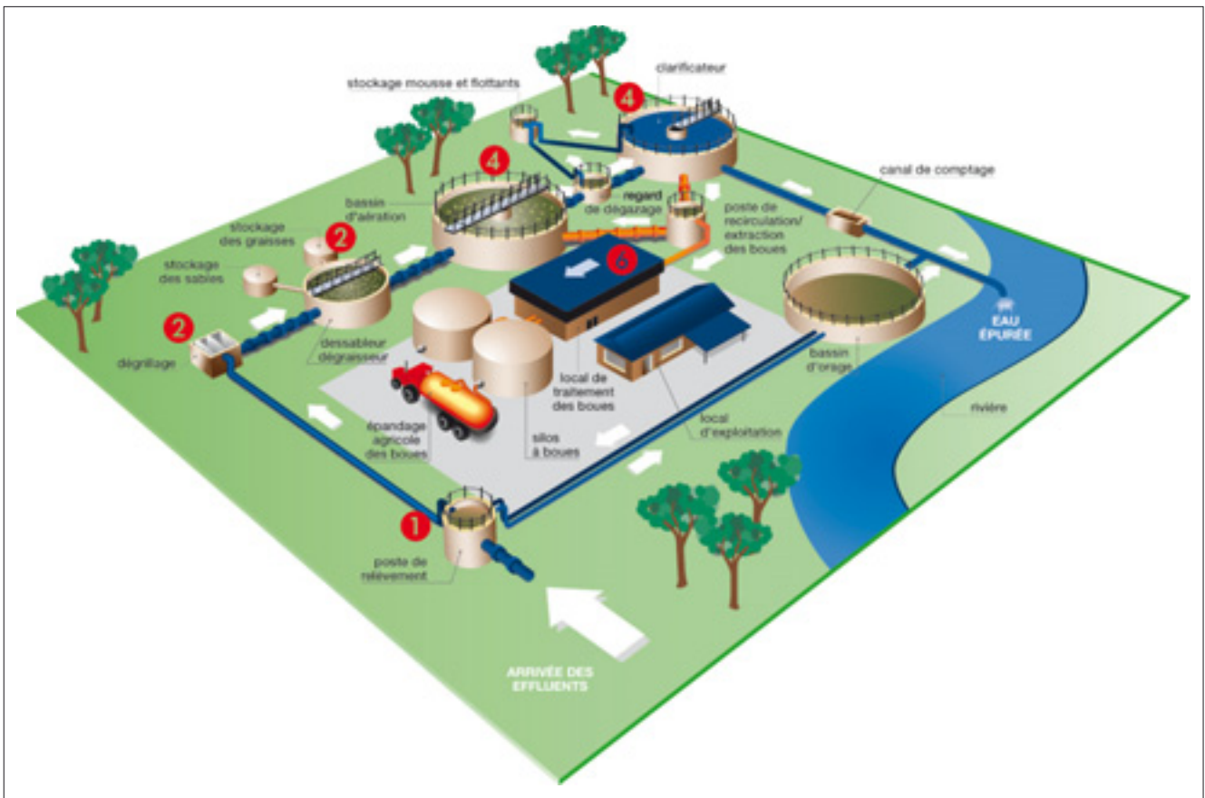
Figure 1 Exemple d'installation avec traitement par boues activées.
