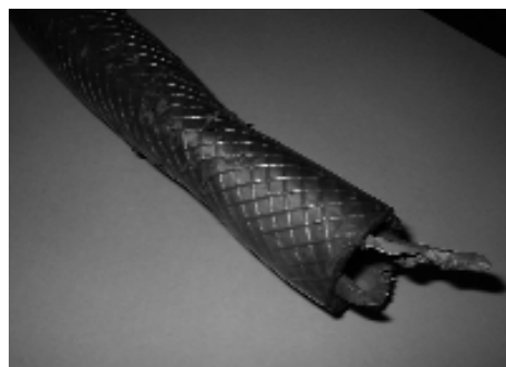
Photo 32. Tuyau de succion d'une pompe flottante, attaqué par un crocodile.
