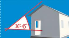
Renforcer les attaches entre les éléments de couverture et la charpente et prévoir des barres de retenue anti-cyclonique sur la couverture.
