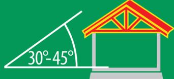
Les toitures légères résistent mieux aux effets des séismes. Toute toiture doit être conçue pour minimiser le risque d'effondrement: ceci dépendra de la structure d'appui qui doit être stable.
