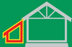
Réduire le risque de dégâts en séparant extensions et vérandas de la structure principale.
