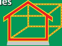
Les bâtiments compacts et symétriques résistent mieux aux séismes et aux cyclones.
