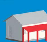
Ne pas construire plus d'un étage en maçonnerie.
