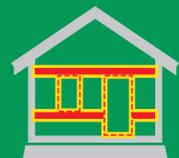
La taille, forme et position des ouvertures influencent la résistance d'un bâtiment aux séismes et cyclones.
