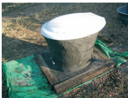
Photo 6-24 : Siège finalisé en durcissement
