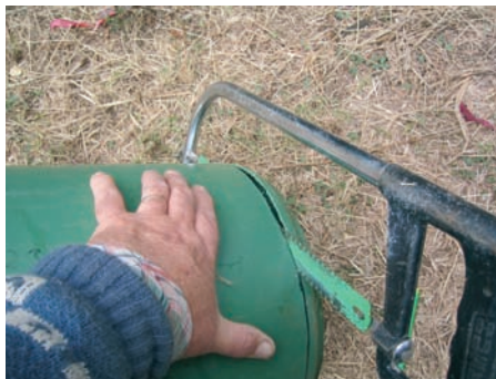
Photo 6-8 : Découpage de la base du seau.
