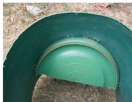
Photo 6-12 : La base découpée est attachée avec du fil de fer
