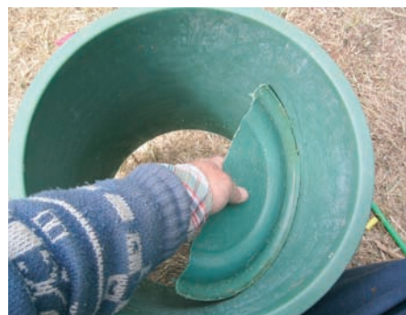
Photo 6-11 : Placement de la base à mi-hauteur du seau de façon à former un angle
