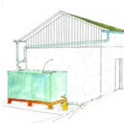
Les attaches des gouttières en dessous des tôles ondulées (ou autre matériau) du toit doivent permettre à l'eau de s'écouler vers le système de collecte, sans stagner et sans pertes.
