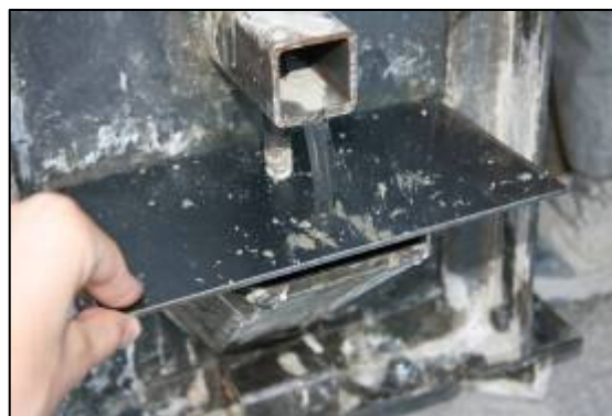
La plaque de nez doit être sécurisée avec le tuyau en plastique sortant par le trou
