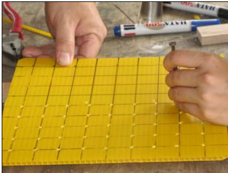
Un diffuseur en plastique ondulé avec des trous bien placés
