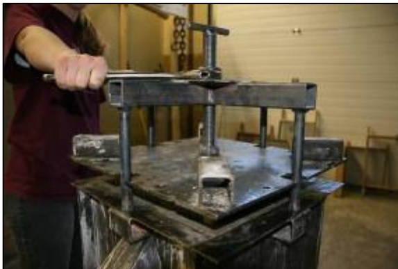
Étape 8 - Serrez l'écrou sur l'extracteur pour décoller le moule intérieur
