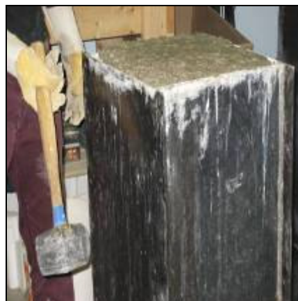
Étape 8 - Vibrer le moule avec une masse en caoutchouc pour aider l'évacuation de l'air
