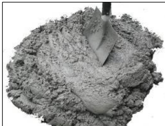
Le béton devrait être de consistance assez dure et sèche. Le filtre est sujet à des fissures ou des fuites si trop d'eau est ajoutée.
