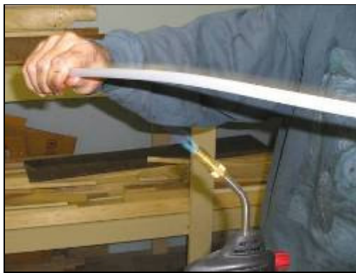
Si le tuyau de polyéthylène est raide, il peut avoir besoin d'être chauffé afin de le plier.
