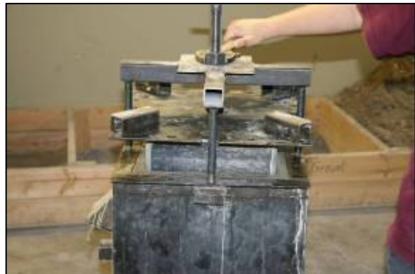
Étape 8 - Serrez l'écrou sur l'extracteur pour décoller le moule intérieur
