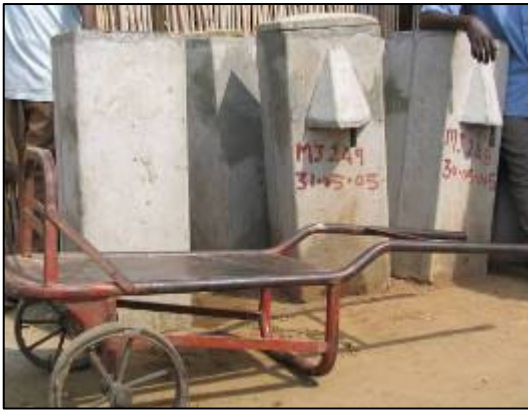
Une charrette spécialement conçue pour le transport des filtres
