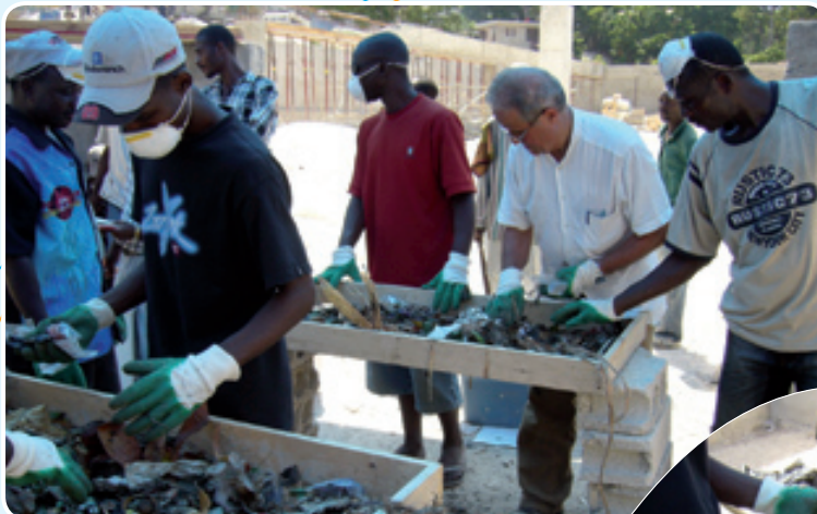
Tri de la fraction intermédiaire sur grille 20mm source : CEFREPADE, 2009
