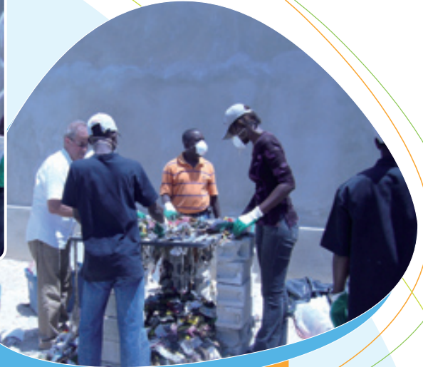
Séparation et tri des éléments grossiers, supérieurs à 100mm source : CEFREPADE, 2009
