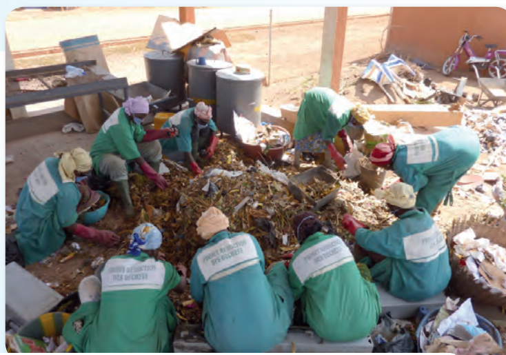
Association de femmes triant et valorisant les déchets plastiques à Ouagadougou (tri par couleur et par matériaux, lavage manuel, broyat mécanique). Le broyat est vendu à des usines de moulage d'objets en plastiques.
